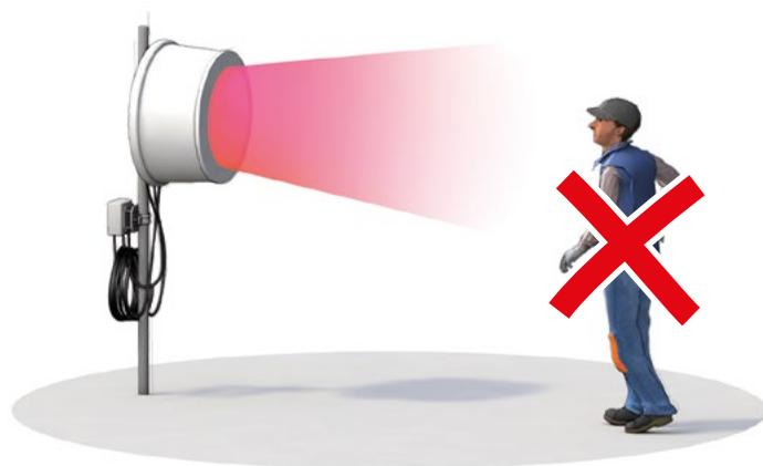
Figure 6. Interdiction de stationner devant une antenne de faisceaux hertziens
